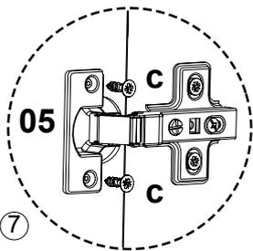
Posicione la pieza 05 en la pieza 01, fijando los herrajes k con 2 herrajes c en cada uno. Repita colocando la pieza 05 restante en la pieza 02.
