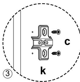
Coloque 3 piezas Base del herrajes k con 6 herrajes c en la pieza 01 y repítalo con la pieza 02.
