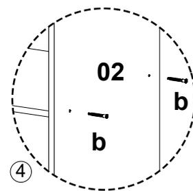
Atornille la pieza 07 entre las piezas 01 y 02 con 2 herrajes b. Atornille las piezas 06 entre las piezas 01 y 02 con 8 herrajes b. Atornille la pieza 08 entre las piezas 01 y 02 con 4 herrajes b.
