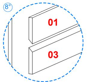
Para fijar la pieza **03** a la pared utilice los herrajes **c** y **d**. Nivelar y luego colgar el panel de TV.
