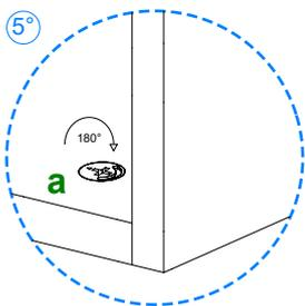
Posicione la pieza **06** sobre la pieza **05** y gire los herrajes **a** hasta que la flecha señale el sentido opuesto.
