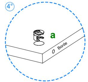
Coloque en la pieza **05** 2 herrajes **a** con la flecha hacia el borde.
