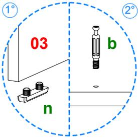
Coloque en la pieza **02** y **03** 2 herrajes **n** como se indica. Atornille en las piezas **02** y **03** 2 herrajes **b**, y en la pieza **11** 4 herrajes **b**.
