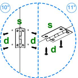
Posicione la pieza **10** con la pieza **09** y atornille los herrajes **s** con 4 herrajes **d** en cada una. Atornille en la pieza **01** 2 herrajes **s** con 2 herrajes **d** como se indica.
