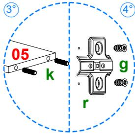
Coloque en las piezas **04** y **05** 4 herrajes **k**. Coloque en la pieza **08** 2 herrajes **k**. Coloque en la pieza **02** 2 **Partes Base** del herraje **r** con 4 herrajes **g** como se indica.
