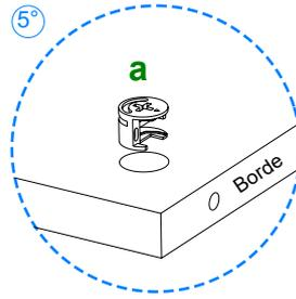
Coloque en las piezas **02**, **03** y **08** 2 herrajes **a** con la flecha hacia el borde. Posicione entre las piezas **02** y **03** las piezas **04**, **05**, **08** (2 herrajes **t**) y gire los herrajes **a** hasta que la flecha señale el sentido opuesto.
