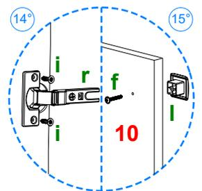
Coloque en la pieza **10**, 2 **Partes Bisagra** del herraje **r** con 2 herrajes **i**. Posicione el ensamble anterior en la pieza **02** y ajuste los tornillos. Atornille en la pieza **10** 1 herraje **l** con 1 herraje **f**.
