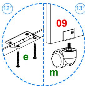
Posicione la pieza **01** con la pieza **06** y atornille el herraje **s** con 2 herrajes **e** como se indica. Coloque 1 herraje **m** en la parte inferior de las piezas **09** y **10**.
