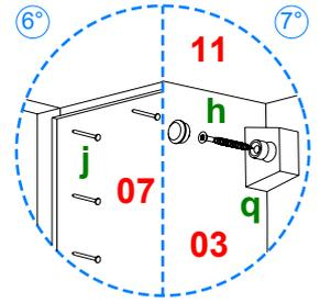
Ponga el mueble boca abajo y corrobore que quede en perfecta escuadra. Proceda a clavar la pieza **07** al mueble mediante los herrajes **j**. Coloque en las piezas **02** y **03** los herrajes **q**, fije el mueble a la pared con herrajes **h** y **p**.
