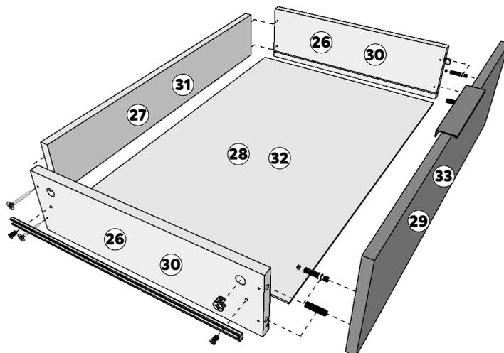
**14a** En las piezas 26 colocar un herraje “a” y uno “i” en uno de los extremos, cuidando de hacerlo en extremos opuestos de cada pieza y que la flecha del herraje “a” apunte hacia el borde perforado. De manera similar, **solo** en las piezas 30 se deben colocar dos herrajes “a” en cada una y no se colocan los herrajes “i”.
