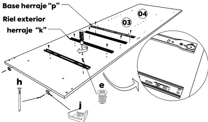
**1b** Separación de los herrajes **“k”**. Extender la corredera, manteniendo fijo el riel exterior y tirar hacia afuera el riel interior hasta no correr más. En la parte interna, en la unión entre ambos rieles, se encuentra una pieza plástica de forma alargada y curva que es el mecanismo que evita su separación, para accionarlo debe empujarse sobre la cara interna del riel interior, en el mismo sentido de la curva mientras tira de los rieles hasta separarlos completamente.
