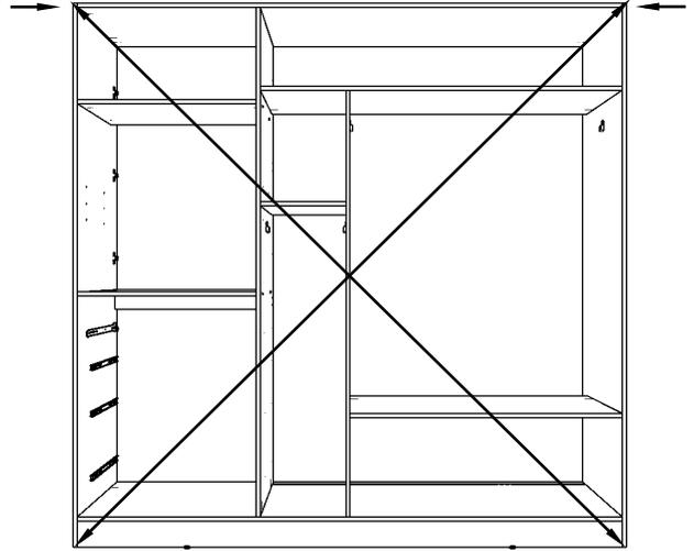
**12** Colocar las piezas **17, 18 y 19** (fondo) sobre los bordes descubiertos dejando el lado blanco hacia la parte interior y fijarlas con los herrajes "h" y "y" (donde se indique). Colocar primero la pieza **17** observando de alinearla a las piezas **02 y 04** manteniendo una separación de 2 mm (aprox.) en los bordes, cuidando de colocar los herrajes "ab", "ac" y "ad" entre las piezas **18 y 19** como se indica.
