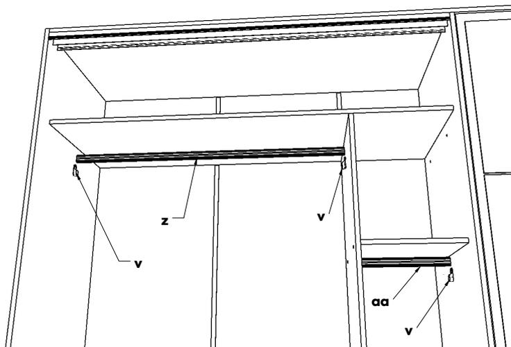
**21** Antes de instalar las puertas correderas (piezas 14) se deben soltar los herrajes “u”. Para ello, aflojar la tuerca de ajuste girando en sentido antihorario, luego repita el procedimiento con el tornillo de ajuste de manera que la rueda se desplace libremente en sentido vertical.
