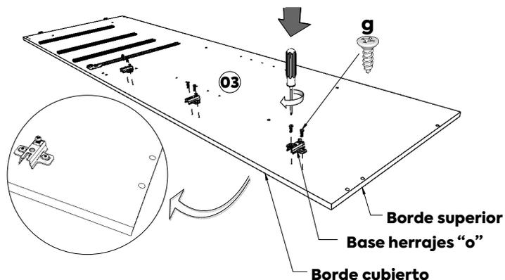
**1d** En la pieza **02** colocar en cada costado un herraje “i” en el agujero más cercano al borde cubierto (diámetro 8 mm) y ejercer presión hasta que encajen completamente.
