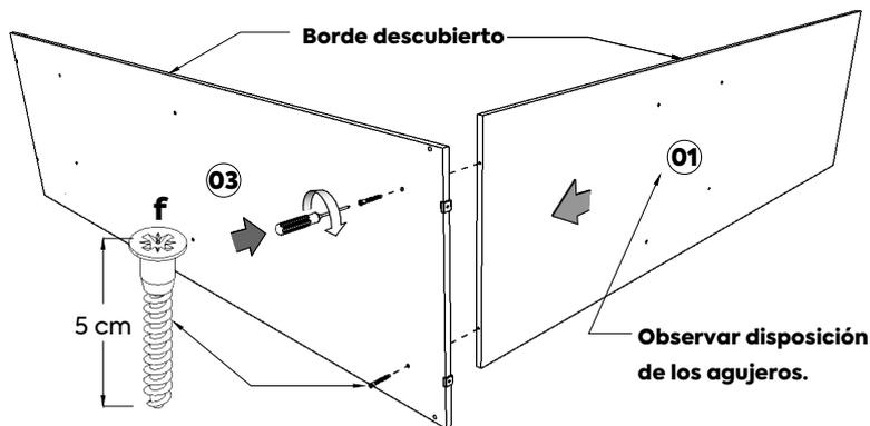
**3** Colocar las piezas **10** y **12** verticalmente de manera similar a la pieza **01** y unir cada una con la pieza **03** haciendo uso de dos herrajes “f” en cada una. Por último, colocar la pieza 13 y unir por medio de la parte sobrante de los herrajes “i”.
