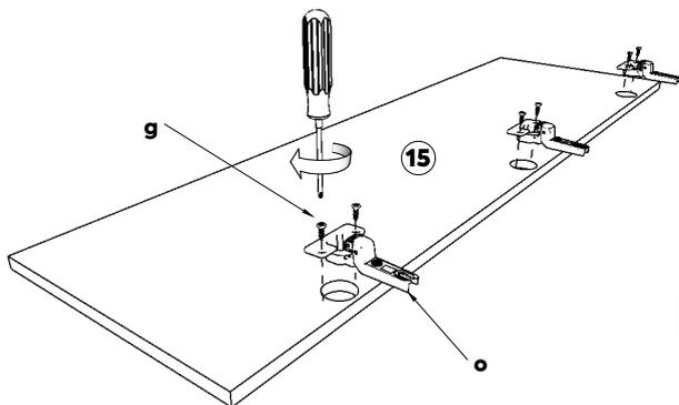
**17** Colocar las piezas **15** (puertas), alineando cuidadosamente ambas partes de los herrajes "o" (base y bisagra) hasta que encajen completamente y ajustar el tornillo indicada
