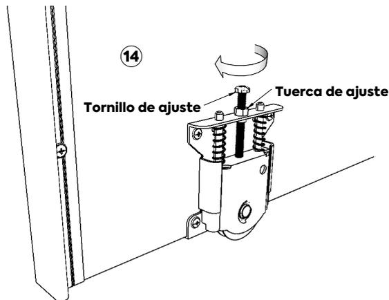
Si gira el tornillo de ajuste en sentido horario ese lado de la puerta sube, y por el contrario, si gira el tornillo de ajuste en sentido antihorario ese lado de la puerta baja.
