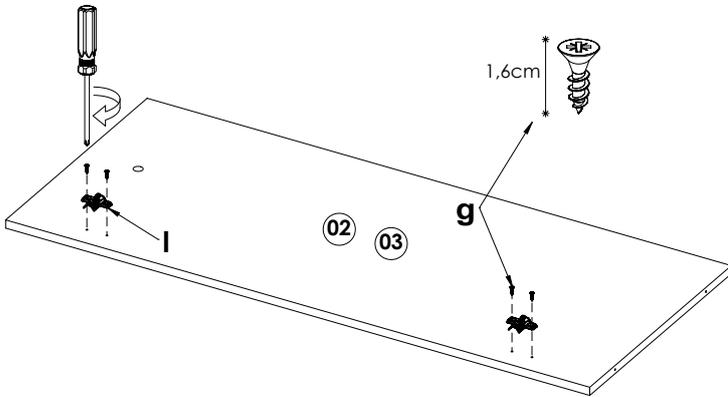
**1b** En la pieza **01**, colocar cuatro herrajes "b" y atornillar hasta el tope.
