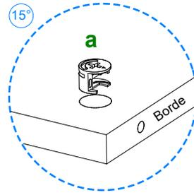
Coloque en la pieza **21** 3 herrajes **a** con la flecha hacia el borde.
