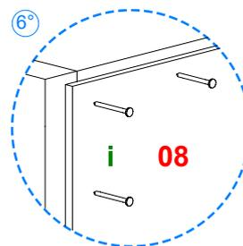
Ponga el mueble boca abajo y corrobore que quede en perfecta escuadra. Procesa a clavar la pieza **08** al mueble mediante los herrajes **i**.
