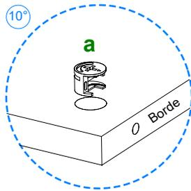
Coloque en la pieza **13**, **16** y **19** 4 herrajes **a** con la flecha hacia el borde.
