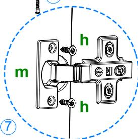
7 Posicione la pieza **12** en la pieza **04**, fijando 2 herrajes **m** con 4 herrajes **h**. Posicione la pieza **12** en la pieza **03**, fijando 2 herrajes **m** con 4 herrajes **h**. Coloque en las piezas **12** 2 herrajes **h**.
