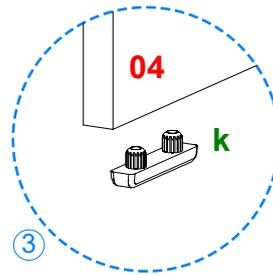
3 Coloque en las piezas **03** y **04** 2 herrajes **k**. Coloque en la pieza **01**, 4 herrajes **k** como se indica.
