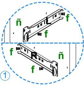
1 Fije con 2 herrajes **f** cada una de las 3 correderas hembra **ñ** marcadas con una **L** en pieza **06**. Fije con 2 herrajes **f** cada una de las 3 correderas hembra **ñ** marcadas con una **R** en pieza **05**.
