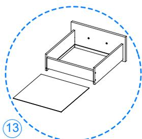
Deslice entre las ranuras la pieza **08** hasta hacer tope y únala a la pieza **13** mediante herrajes **i**.
