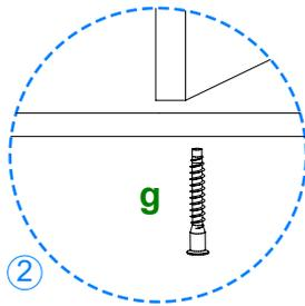
2 Atornille las piezas **05** y **06** a la pieza **01** con 2 herrajes **g** cada una. Coloque en ensamble anterior entre las piezas **03** y **04**. Atornille con 4 herrajes **g**.
